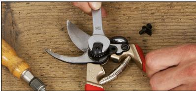
**2. Lösen der Mutter am Gelenkbolzen**
