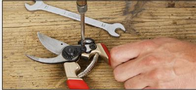
**1. Lösen der Sicherungszahnraсте**
