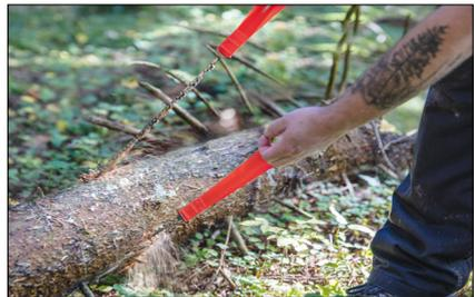
tasche kann entweder am Gürtel getragen oder im Rucksack verstaut werden. Nachschärfbar mit einer 4 mm-Ketten-sägefeile z. B. Nr. 704444. Packmaß: 119 x 107 x 30 mm. Blattlänge 650 mm Gesamtlänge 1500 mm 132 g **Nr. 712370**
