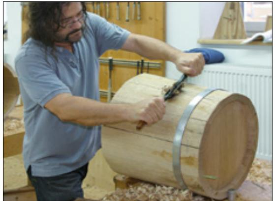
**Inhalt:** Der Kurs vermittelt Grundkenntnisse eines vom Aussterben bedrohten Handwerks. Vom Aufriss über die Bearbeitung und das Fügen der einzelnen Dauben, das Einarbeiten des Bodens, das Abbinden mit Eisenreifen bis zum Putzen mit dem Hobel stellen die Teilnehmer mit traditionellem Werkzeug ein kleines, wasserdichtes Holzschaff mit oder ohne Handdauben her. Dank unserer beiden erfahrenen Fass-
