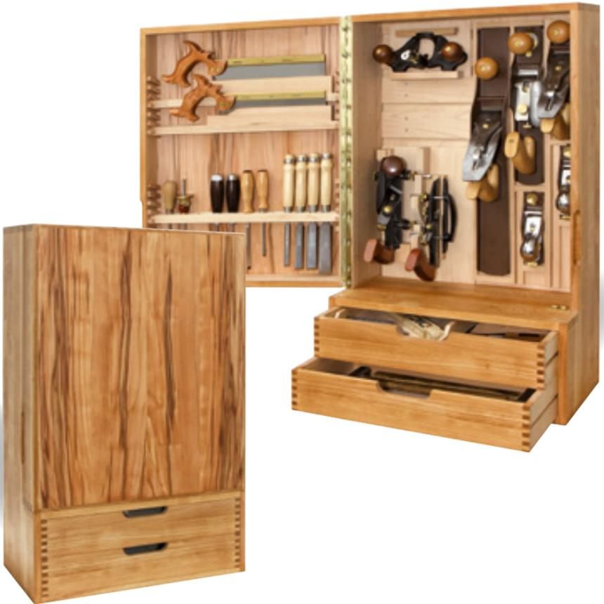
Bei diesem Werkzeugschrank werden die Korpus-Eckverbindungen mit Handmaschinen gearbeitet. Die Herstellung mit Handwerkzeugen wird besprochen. Umgesetzt werden auch praktische und sinnvolle Möglichkeiten von Inneneinteilungen, die Sie ganz nach Ihrem Bedarf auswählen und gestalten können.
