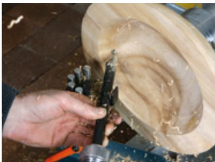
an tieferen oder leicht hinterschnittenen Objekten gearbeitet. Für das Drechseln nach Anleitung (Zeichnung) hat der Kursleiter einfache Objekte vorbereitet. Sie können, unter professioneller Anleitung, auch eigene Projektideen umsetzen.
