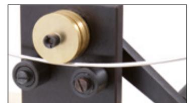
der Bundierungsarbeiten. Massives Werkzeug mit verstellbarem Biegeradius. Kann auf der Werkbank montiert werden.
