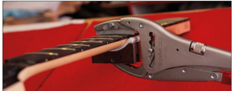
Weiche und sehr genaue Bewegungen ermöglichen einen effektiven und mehrfachen Druck. Die Anwendung erfolgt mit einer Hand, da durch die einfache Bedienung keine Kraft erforderlich ist. Müheloser und schneller Austausch der Einsätze ohne Schrauben und Inbusschlüssel.
