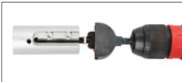
Besonders vorteilhaft bei Verwendung von Herdim System-Wirbeln. Die weit verbreiteten Wirbeldurchmesser 7,8 und 8,2 mm passen sowohl in neue als auch in neu ausgeriebene Wirbellöcher.
