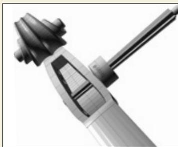
2. Die entsprechende Bohrung wird mittels einer Herdim-Reibahle und kalibriertem System-Anschlagring passgenau aufgerieben.
