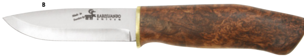
B NORDISCHES JAGDMESSER Ideal für Jagd und Trekking: Kräftige, rostfreie Sandvik-12C27-Klinge, ergonomischer Griff aus gebeizter Maser- birke, Messinghandschutz, Lederscheide mit Gürtelhalfter. Härte 57 HRC.
