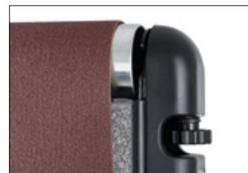
Ein Graphitbelag unter dem Schleifband sorgt für weniger Reibung und Hitze. Dadurch erhöht sich die Lebensdauer des Schleifbandes erheblich.
