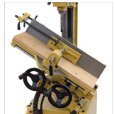
Das komplette Kreuzsupport lässt sich bis max. 35° neigen, für schräg einzustemmende Zapfenlöcher unverzichtbar.
