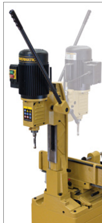
Der komplette Spindelkopf kann um 180° gedreht werden um selbst große Werkstücke, z. B. Türen, problemlos zu bearbeiten.
