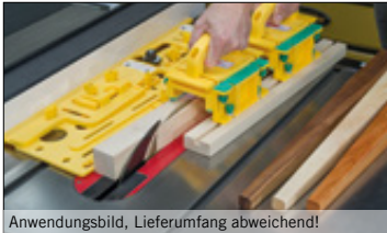
Anwendungsbild, Lieferumfang abweichend! Für noch mehr Sicherheit können bis zu zwei GRR-RIPPER ADVANCED Schiebelöcher angebracht werden.
