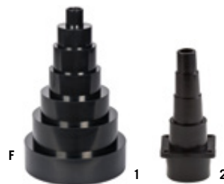
1 Anschlussstutzen, 7 Abstufungen (AD/ID) 25/19, 50/43, 63/56, 75/68, 100/93, 125/118 und 152/145 mm Durchmesser. Nr. 720550 6,13 € 7,30 €
