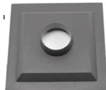
I ABSAUGWANNE Rechteckiger Anschluss aus Kunststoff mit Anschlussstutzen für 100 mm-Absaugschläuche. Die flache Wanne kann dort eingesetzt werden, wo für herkömmliche Trichter kein Bauraum vorhanden ist. Zum Auffangen und Absaugen von Spänen an z. B. Tischsägen, Abricht-hobelmaschinen und überall dort, wo keine spezifischen Absauganschlüsse vorhanden sind. Außen-Ø 100 mm, Innen-Ø 90 mm. Anschluss 311 x 311 mm Nr. 727648 12,52 € 14,90 € 343 x 203 mm Nr. 727649 12,52 € 14,90 €
