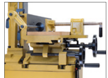
Das aus Gusseisen gefertigte Kreuzsupport mit Werkstückanschlag und einstellbaren Schwalbenschwanzführungen kann mittels zweier Handräder in X / Y-Achse verfahren werden.
