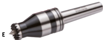
E SORBY™ MITLAUFKÖRNER STEBCENTRE, MK2 Dieser Mitlaufkörner wurde in langjähriger Entwicklungsarbeit von dem norwegischem Drechsler Petter Herud entwickelt. Er weist den unvergleichbaren Sicherheitsstandard eines Steb-centres auf und ermöglicht exzentrische Einspanntechniken. Morsekegel MK 2 Gesamtlänge 130 mm Ø 13 mm Nr. 720381 22 mm Nr. 720379 32 mm Nr. 720380
