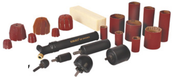
F SCHLEIFKÖRPER-SATZ NR. 101 FÜR KIRJES® SCHLEIFSYSTEM Satz enthält: Schleifkörper, zylindrisch Ø 20 x 32 mm (Nr. 120); Schleifkörper, zylindrisch Ø 28 x 80 mm (Nr. 130); Schleifkörper, zylindrisch Ø 42 x 44 mm (Nr. 140); Schleifkörper, ballförmig Ø 42 x 35 mm (Nr. 140R); Schleifkörper, ballförmig Ø 20 mm (Nr. 120R); je fünf Schleifhülsen pro Körnung 80, 150 und 320; Luftpumpe; Reinigungs-Stick. Nr. 707435
