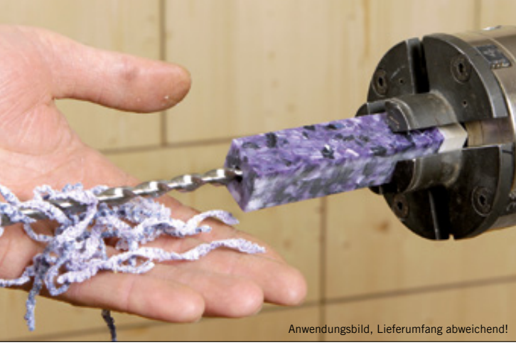
D FISCH® MASTER PEN DRILL Long Life Q Der Pen Blank-Bohrer aus M2-HSS mit seinen speziellen Spiralnuten ermöglicht exakte und ausrissfreie Bohrungen, egal bei welchem Material. Ein einwandfreier Spanabtransport verhindert Verstopfen des Bohrkanals und mindert die Reibung. 64 HRC, lange Standzeit und längere Wartungsintervalle, bis zu 1350 Bohrungen ohne Nachschärfen. Besonders geeignet für Drechslerarbeiten wie Tieflochbohrungen in Hirnholz z. B. bei der Schreibgeräteherstellung. Für Weich- und Hartholz, Acryl und Aluminium.
