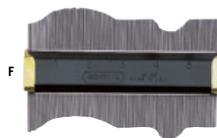
F KONTURSCHABLONE MIT STAHLNADELN Besonders hohe Übertragungsgenauigkeit durch feine Tastnadeln aus Edelstahl. Nadelndurchmesser 0,75 mm. Millimeter-Skala. Arbeitstiefe 50 mm, Gesamtlänge 150 mm Nr. 707167 Arbeitstiefe 105 mm, Gesamtlänge 300 mm Nr. 717142
