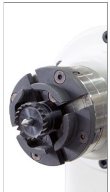
G SORBY™ MITNEHMER STEB CHUCK DRIVE Spart Zeit und Aufwand: Der Sorby-Mitnehmer Steb Chuck Drive kann einfach auf dem bereits montierten Spannfutter eingesetzt und geklemmt werden. Zeitaufwendiges Umbauen entfällt daher. Passend für Spannfutter Talon Nr. 702159 / 60, Stronghold Nr. 702158 und SuperNOVA2 Nr. 720670 / 71 / 720753 . Gesamtlänge 50 mm Ø 13 mm Nr. 720377 22 mm Nr. 720378 32 mm Nr. 720376
