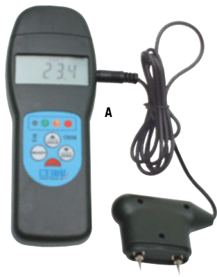
A HOLZFEUCHTE-MESSGERÄT MIT ELEKTRODEN- UND ZERSTÖRUNGSFREIEM MESSMODUS Nichts ist ärgerlicher als Trockenrisse oder starker Verzug, wie sie nach der
