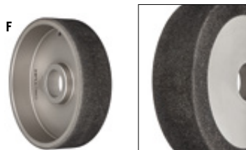
Beschichtet mit schwarzen CBN Kristallen für extralange Standzeit bei der Bearbeitung von gehärteten Werkzeugstählen.
