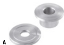
A DICTUM® AUFNAHMEFLANSCH MIT ANPRESSPLATTE Durch den Aufnahmeflansch wird die 32 mm Standardbohrung der CBN-Schleifscheiben auf den Wellendurchmesser der verschiedenen Schärfmaschinen reduziert. Aus Aluminium. Für DICTUM CBN-Schleifscheibe Nr. 715287.
