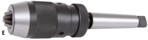
E SCHNELLSPANNBOHRFUTTER ECO MIT KEGELDORN Sehr gutes Preis-Leistungs-Verhältnis. Schnellspannbohrfutter für Handwerk und Hobby. Für die Verwendung an Drehsel-, Fräs- und Ständerbohrmaschinen. Selbstspannend und hohe Spannkraft. Schlüssellos, Spannen und Öffnen erfolgt mühelos mit der Hand. Spannweite 0,5-16 mm, Spannbacken lassen sich komplett öffnen und ohne Lücke schließen. Rundlaufgenauigkeit 0,08 mm, Kegelaufnahme B 16, Innenkegel DIN 238. Für Rechtslauf. Gesamtlänge 215 mm
