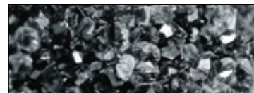
Beschichtet mit schwarzen CBN Kristallen für extralange Standzeit bei der Bearbeitung von gehärteten Werkzeugstählen.
