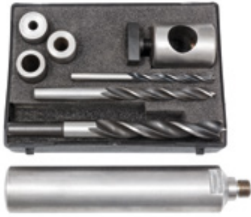
C BOHRVORRICHTUNG FÜR DIE DRECHSELBANK Bohrlehre zum Einspannen in die Handauflage einer Drechselbank. In Kombination mit jeder Handbohrmaschine können präzise Bohrungen in ein eingespanntes Drehselobjekt gebohrt werden. Zusammen mit einer Teilscheibe (auf Sonderbestellung erhältlich) werden so Bohrungen in verschiedenen Teilungen präzise in Drehselobjekte gebohrt. In diese können auch Fremdholz-Dübel eingeleimt werden, so entstehen dekorative Muster. Für Handauflagen mit Einsteckzapfen Ø 30 mm.
